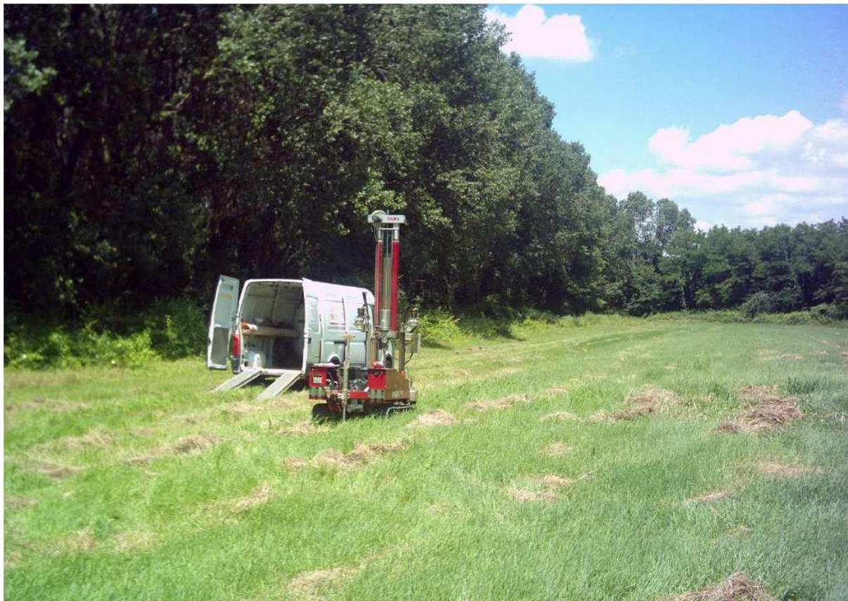
Prova penetrometrica statica n° 5 bis
