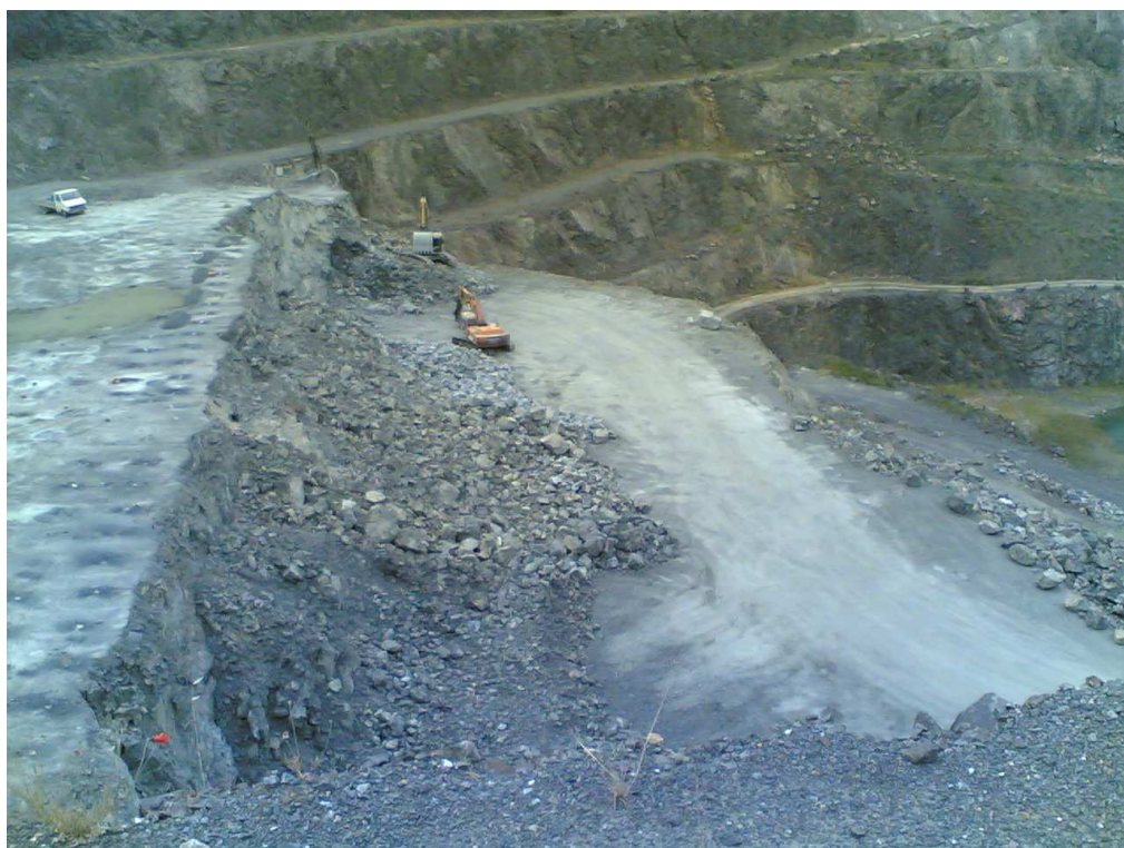
Foto 6 : Vista del gradone Sud 0/-10 m s.l.m. (spianata a -10, in sgombero)
